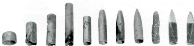
Artefacts montrant les étapes de fabrication de la balle (haut) et de la douille (bas) de la cartouche .303.
