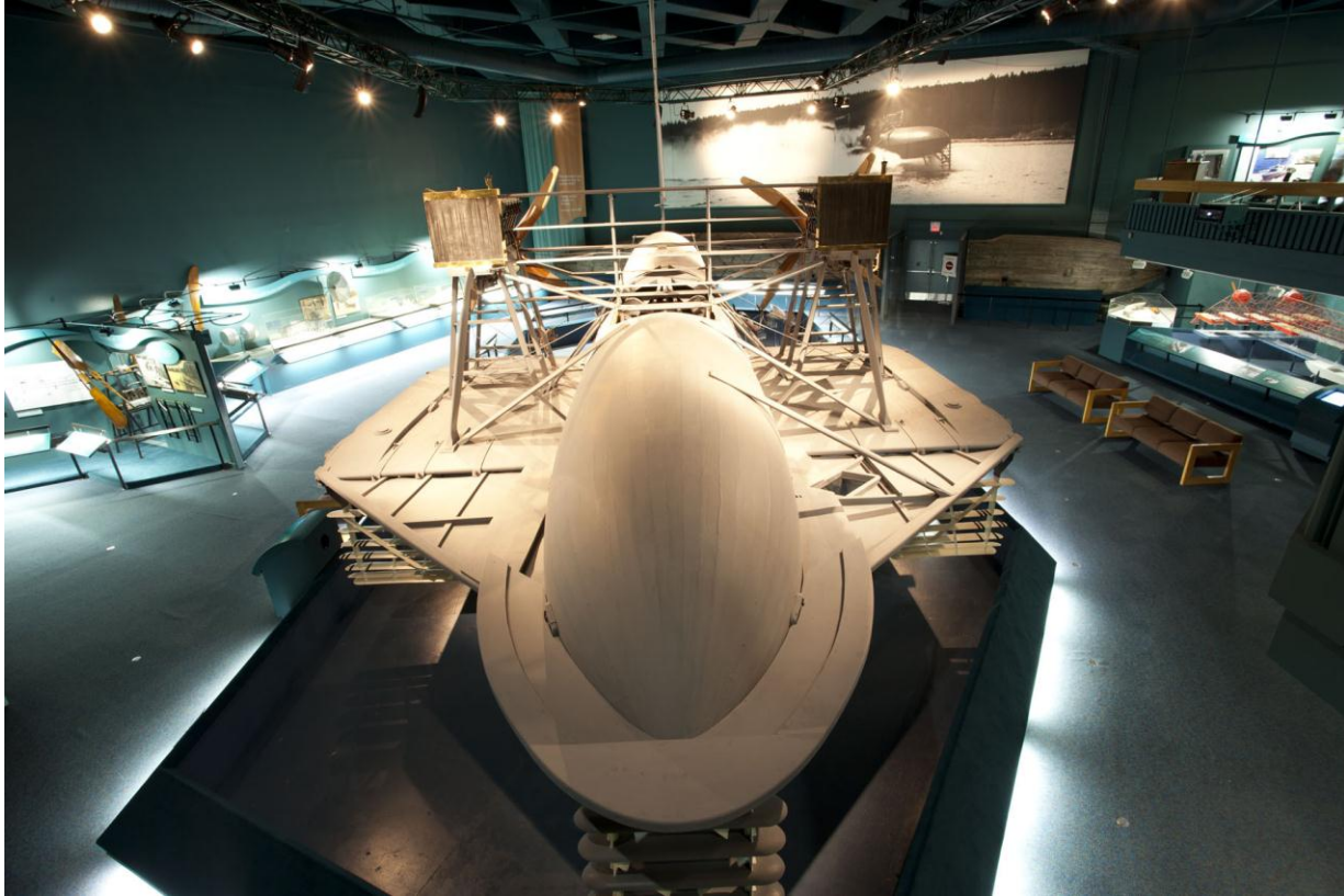
Figure 9 : Reproduction grandeur nature de l'hydroptère HD-4 de Bell et Baldwin, qui avait établi des records de vitesse. La coque originale est visible juste à côté.
