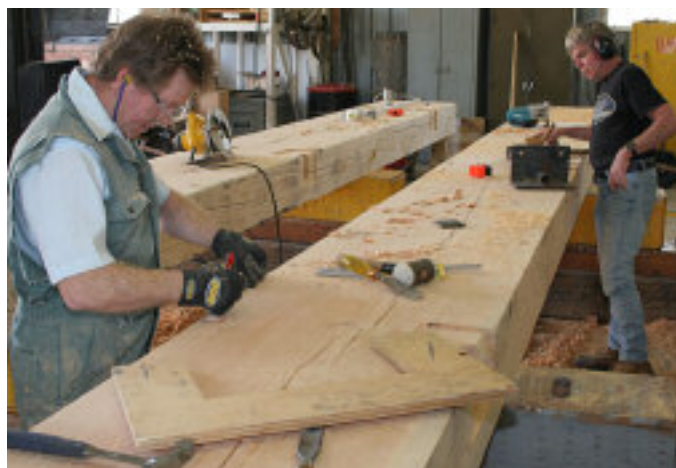
Les portes ont une durée de vie d'au plus vingt-cinq ans. Les nouvelles portes sont fabriquées par des artisans de l'Agence Parcs Canada, d'après les modèles d'origine.
