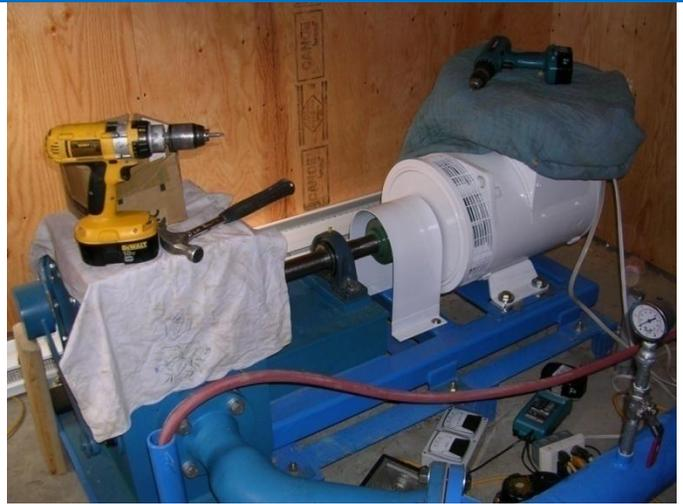
**Photographie 2:** Unité de microproduction d'hydroélectricité
