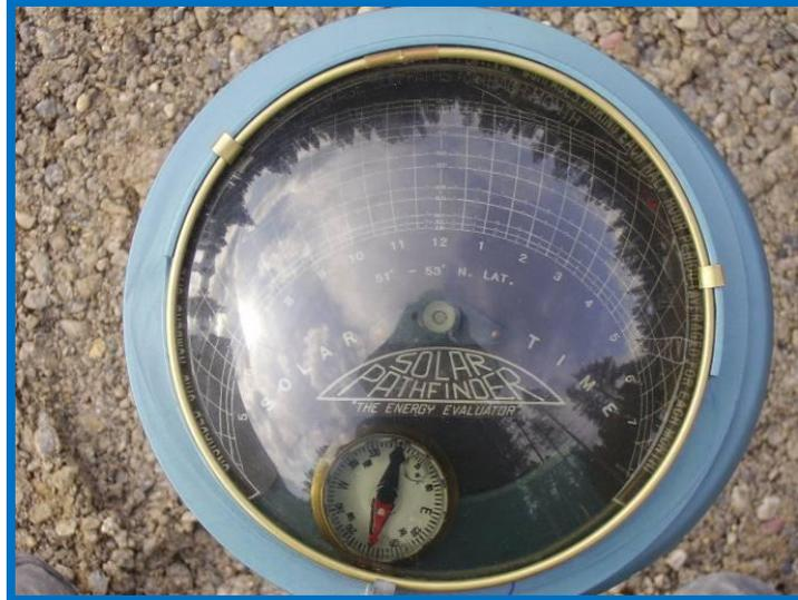
**Photographie 1.** Appareil Solar Pathfinder<sup>MC</sup> utilisé à l'installation de la station du lac Maligne.
