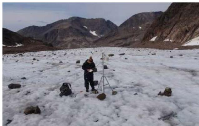
*Installation d'un capteur de température sur le glacier Hidden*
