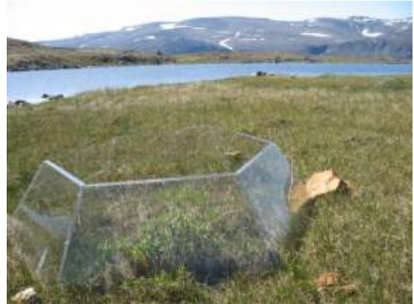
*Chambres à dessus ouvert permettant de simuler le réchauffement climatique en milieu humide – on a étudié les mousses dans ces mini-serres.*
