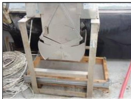
(a) Carottes rectangulaires utilisées pour recueillir des sédiments et des échantillons de biote.
