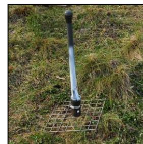
*L'installation d'un tube de gel, doté d'un écran permettant de mesurer le soulèvement par le gel, à la baie de Ramah.*
