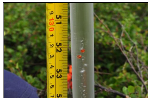
Des billes de verre ont été placées dans le tube intérieur rempli d'eau pour indiquer l'épaisseur de la glace.
