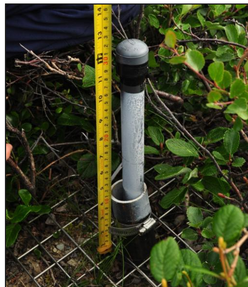
Prise de mesures sur un tube de dégel à la baie Ramah.
