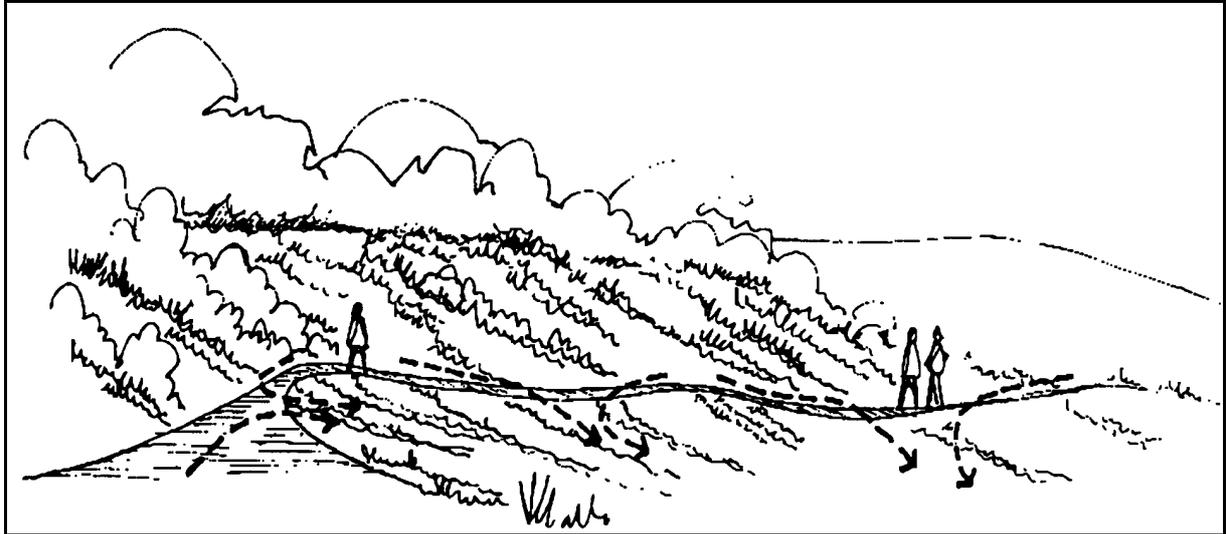
Lorsqu'on peut éviter les pentes abruptes, il est bon de faire zigzaguer le sentier afin de conserver les pentes optimales (voir la section 1.3.1, 3).
