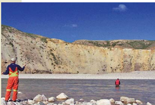
Des techniciens de relevés hydrologiques mesurent le débit sur la rivière Hornaday. PHOTO : DIVISION DES RELEVÉS HYDROLOGIQUES DU CANADA
