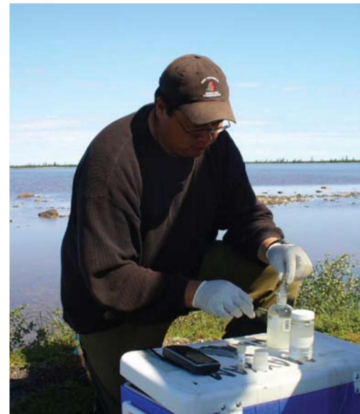
Rodney Redhead prend une mesure de l'eau in situ au lac Mary, à l'aide d'un multimètre YSI 556.0
