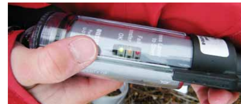
Légende : Téléchargement des données de l'enregistreur in situ à WW4. Source : Heather Stewart
