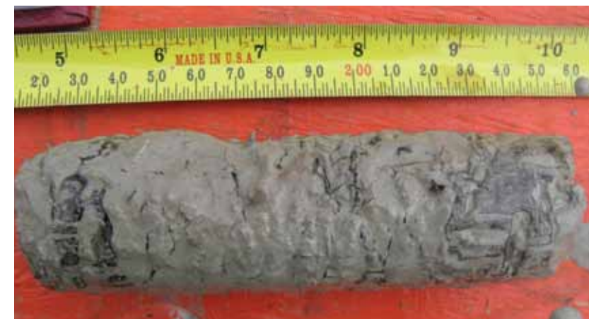
Carotte de sondage montrant des lamelles de glace dans le sol minéral trouvé sous la tourbe d'un plateau palsique. Échelle en centimètres et en pouces. Source : Wendy Sladen
