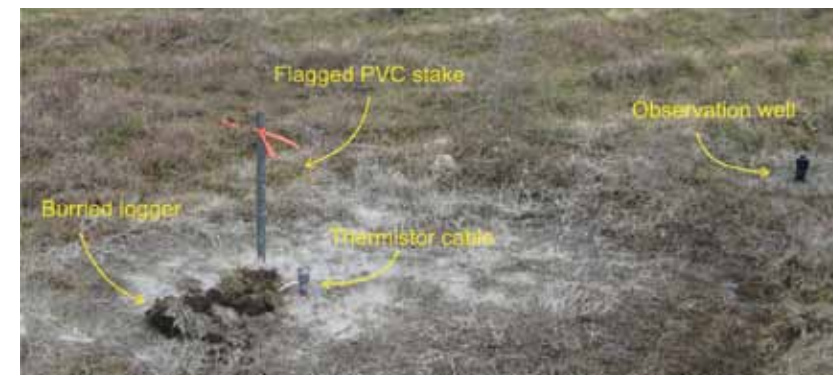
Installation typique. Ce site particulier est une tourbière minérotrophe. Source : Wendy Sladen
