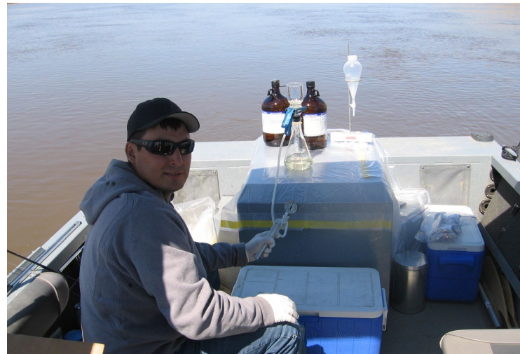
Kevin Courtoreille (programme de surveillance communautaire) exécute des titrages pour l'extraction des HAP dans le DPA. Photo par Bruce Maclean
