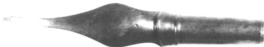
Figure 22. Plaque de fond de la sous-garde d'un fusil Long Land.
